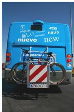
Fig 9. Soporte trasero para transporte de bicicletas en Madrid. Fuente: EMT
