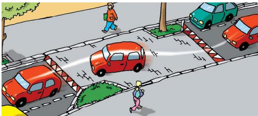
Fig 20. Desviación de trayectoria mediante arbolado. Fuente: RACC
